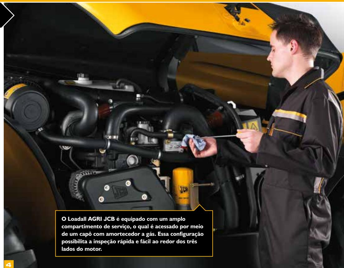
O Loadall AGRI JCB é equipado com um amplo compartimento de serviço, o qual é acessado por meio de um capô com amortecedor a gás. Essa configuração possibilita a inspeção rápida e fácil ao redor dos três lados do motor.
