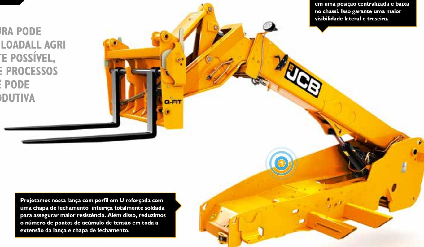
Projetamos nossa lança com perfil em U reforçada com uma chapa de fechamento inteiramente soldada para assegurar maior resistência. Além disso, reduzimos o número de pontos de acúmulo de tensão em toda a extensão da lança e chapa de fechamento.
