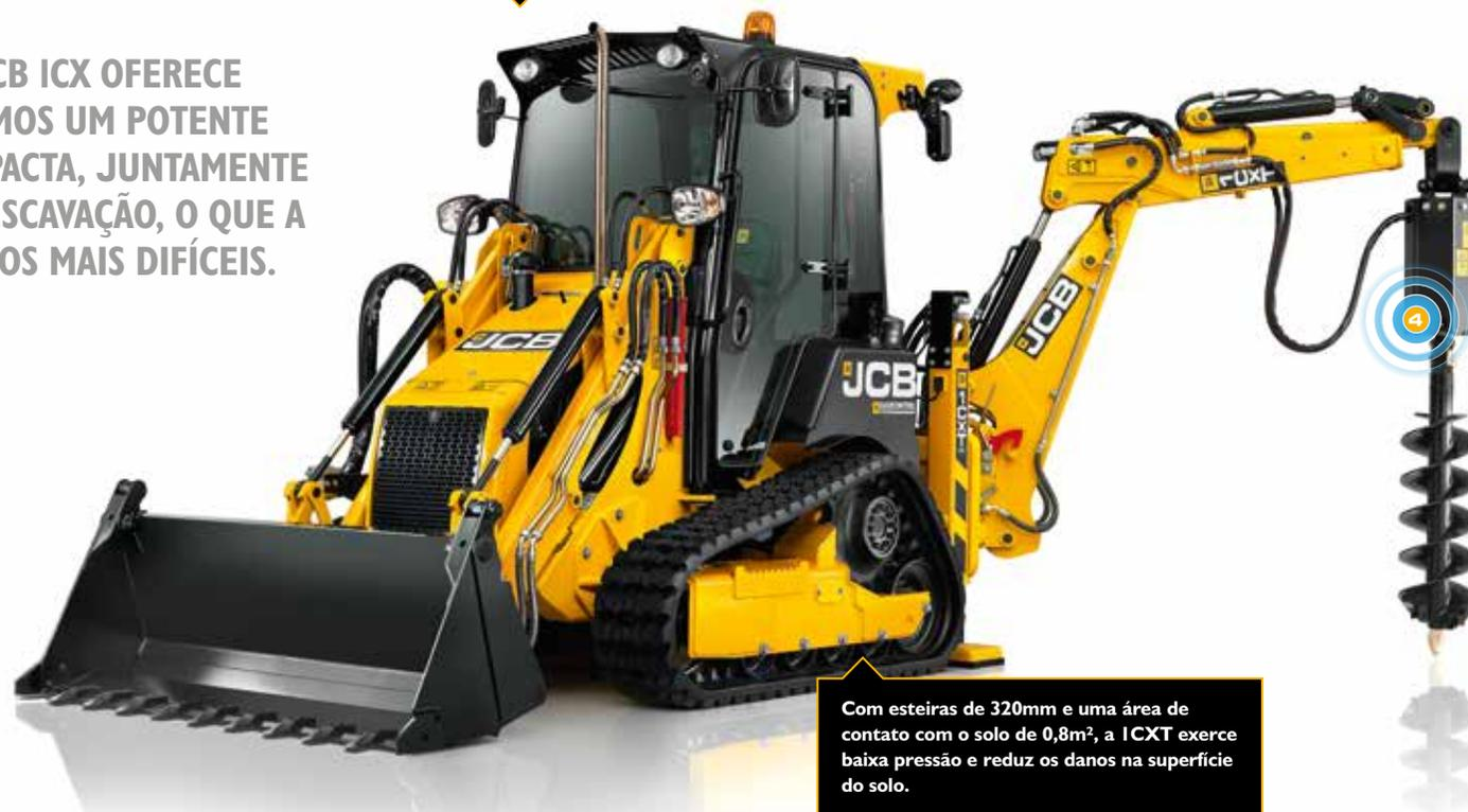
Com esteiras de 320mm e uma área de contato com o solo de 0,8m<sup>2</sup>, a ICXT exerce baixa pressão e reduz os danos na superfície do solo.
